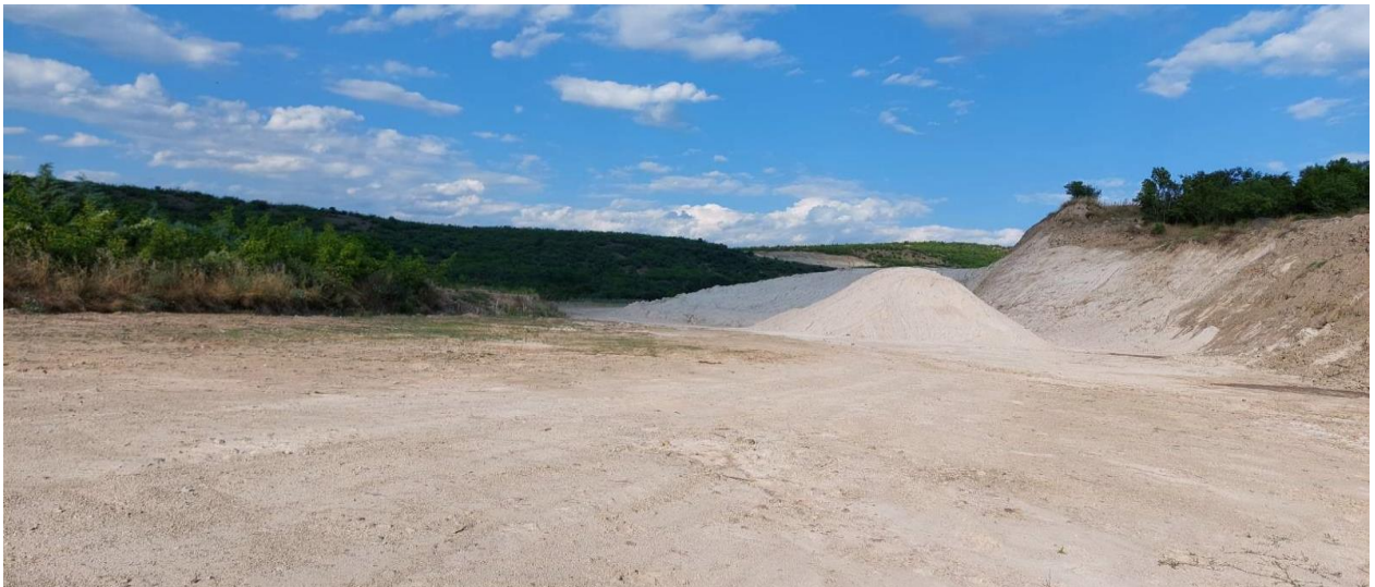
ΕΙΚΟΝΑ 3: Άποψη κοσκινισμένου υλικού ποζολάνης, έτοιμο προς μεταφορά.
